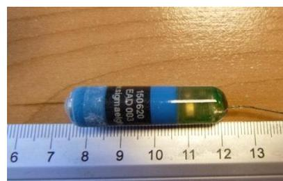
Figure 17 : Emetteur SIGMA EIGHT TX-PSC-I-450 M de 9 g pour 4,5 cm
