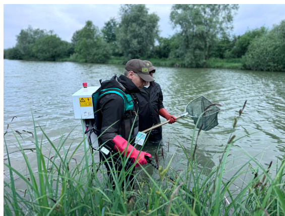
Figure 5 : Illustration d'une pêche électrique. Source : FDPPMA55.
